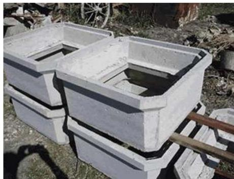
**Aros para pozos, cámara de inspección para instalación cloacal**
